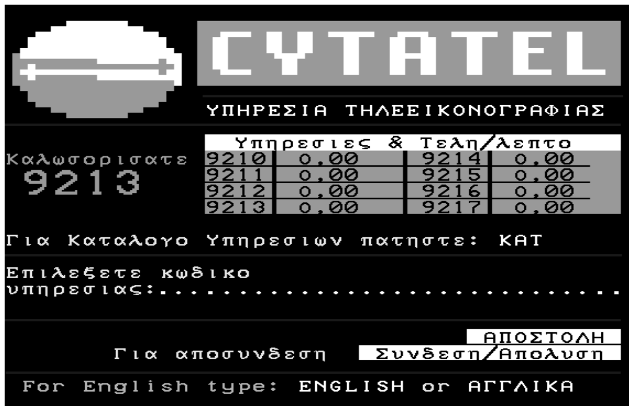
Figure 4-4 Page d'accueil multi-alphabet latin/grec du réseau vidéotex Chypriote, fourni par Monaco Télématique MC-TEL
