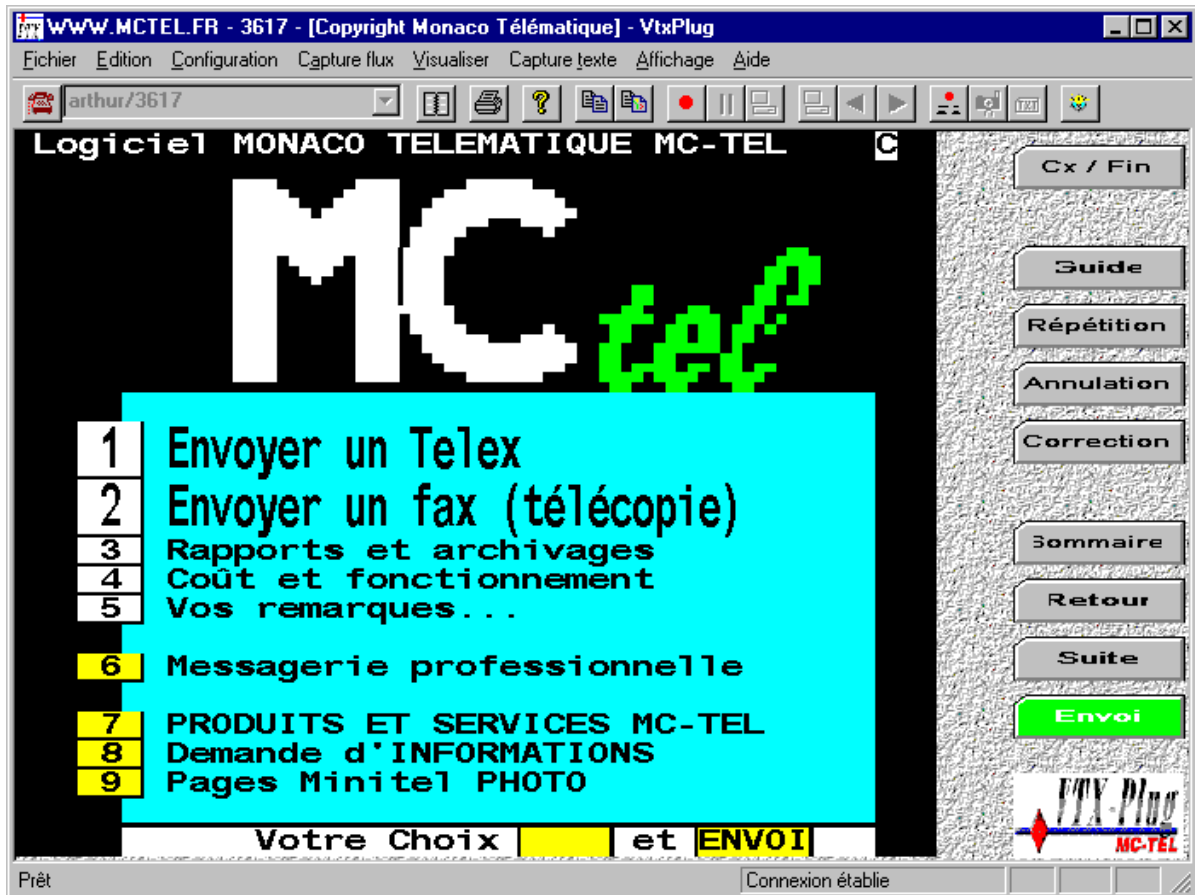
FIGURE 1: Accès au service 3617 MCTEL1 à partir de l'émulateur vidéotex VTX/Plug sur PC/Windows de Monaco Télématique, au travers d'un réseau Intranet
