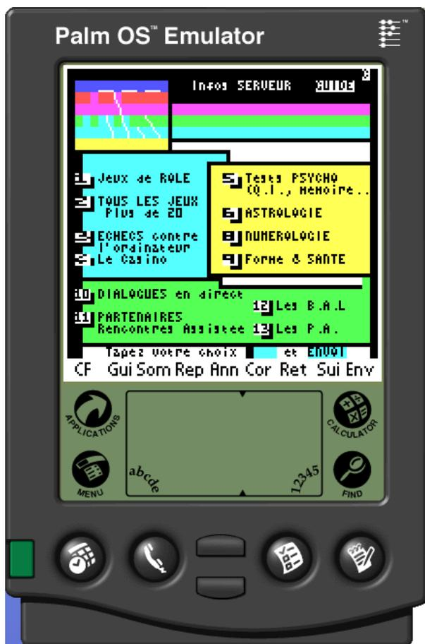
Figure 2-3: l'émulateur VTX/Palm permet aux possesseurs de Palm et compatibles, ainsi que des téléphones Palm intégrés de type Tréo 600, d'accéder immédiatement à une émulation Minitel en mode Modem et par Internet
